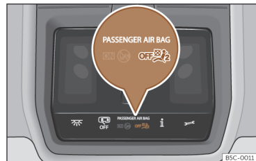
Kuva 44 Kattokonsolissa: poiskytketyn etumatkustajan turvatyynyn merkkivalo.
