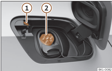
Kuva 68 Latausluukun alla takana oikealla: latausrasia.
