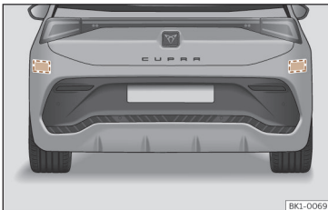
Kuva 121 Auton takaosa: tutkatunnistimien alueet.
