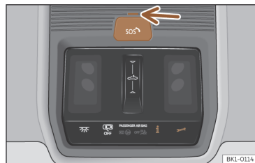
Kuva 61 Kattokonsolissa: puhepalvelujen kytkin.
