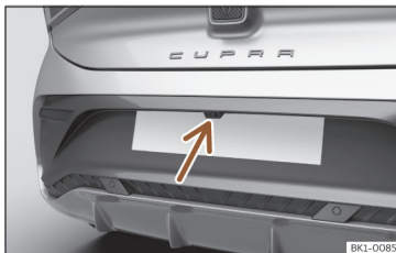
Kuva 123 Takapuskurissa: peruutuskameran sijainti.
