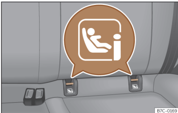
Kuva 52 Takaistuin: ISOFIX- tai i-Size-pidikelenkkien sijainti.
