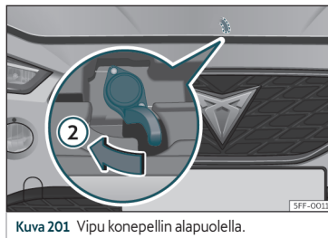
Kuva 201 Vipu konepellin alapuolella.
