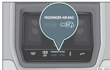
Kuva 16 Kattokonsolissa: Poiskytketyn etumatkustajan eturvatyynyn merkkivalo.
