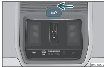
Kuva 32 Kattokonsolissa: puhepalvelujen kytkin
