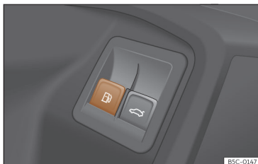
Kuva 214 Kuljettajan ovi: tankkausluukun lukon avaus.
