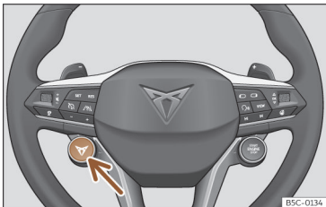
Kuva 161 Monitoimiohjauspyörä: ajoprofiilin vaihtokytkin
