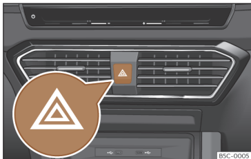
Kuva 98 Kojelauta: varoitusvilkkujen kytkin.
