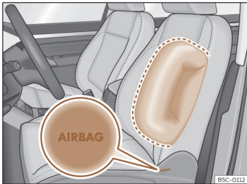
Kuva 25 Sivuturvavyyny kuljettajan istuimessa
