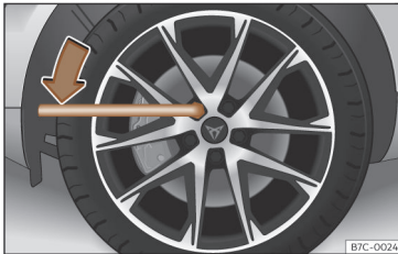
Kuva 42 Pyöränvaihto: pyöränpulttien löysäminen.
