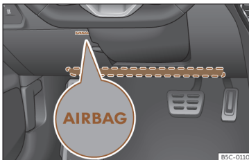
Kuva 21 Kuljettajan polviturvavyön sijainti.
