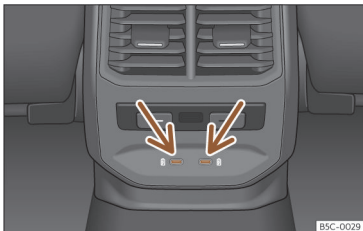
Kuva 155 Keskikonsoli takana: USB-liitäntä lataustoiminnolla.
