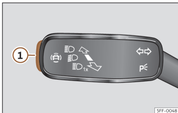
Kuva 66 Vilkku- ja kaukovalovivussa: kuljettajaa avustavien järjestelmien painike (mallista riippuen).
