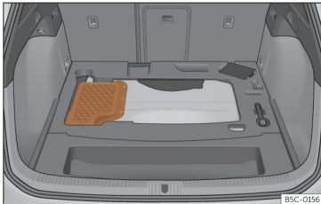
Kuva 229 Lataushybridiautojen (PHEV) akun sijainti tavaratilassa
