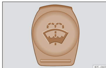
Kuva 228 Moottoritilassa: pesunestesäiliön sininen korkki.
