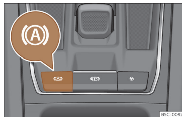
Kuva 190 Keskikonsolin alaosassa: Auto Hold -toiminnon painike.
