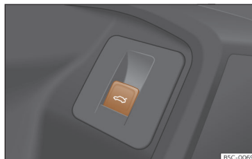
Kuva 89 Kuljettajan ovelsa: takaluukun avaus- ja sulkemispainike.
