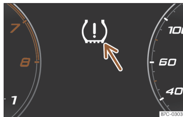
Kuva 234 Mittaristo: varoitus rengaspaineen laskusta.
