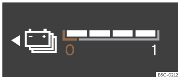
Kuva 63 Digitaalinen mittaristo: akun varaustilan näyttö.
