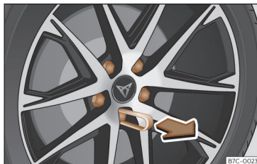
Kuva 40 Pyörä: Pyöränpultit suojuksineen.
