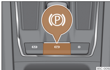
Kuva 189 Keskikonsolin alaosassa: sähköisen seisontajarrun painike.
