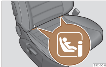
Kuva 32 Etumatkustajan istuin: ISOFIX/i-Size-pidikelenkit.
