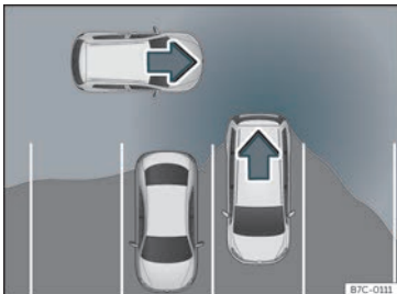
Kuva 224 Kaaviokuva takana risteävän liikenteen varoitimesta: valottava alue kadulle peruuttavan auton takana.
