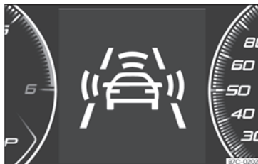
Kuva 206 Mittariston näyttöruudussa: ennakkovaroitukset.
