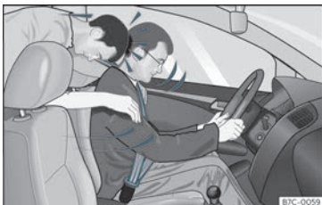
Kuva 78 Takana istuva, turvavyötä käyttämätön matkustaja lennähtää törmäyksessä eteenpäin, edessä istuvan päälle.
